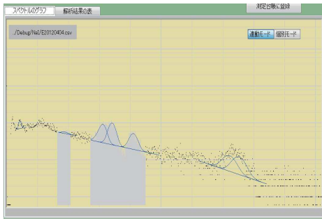
専用ソフトでのピーク分離画面 これにより、核種含有量表示可能
