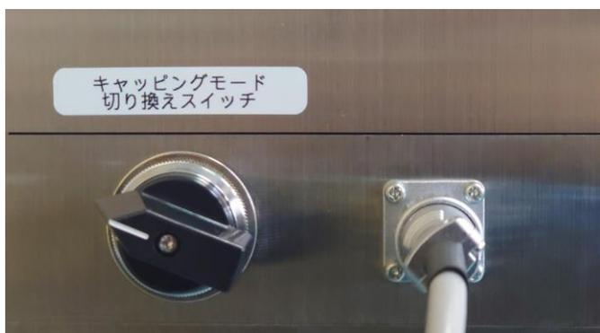
キャッピングするスタート時間の調整、および真空引き無しでのキャッピング動作の切り替えをします。本体裏側より左から、設定圧に到達してから「0秒」「2秒」「4秒」「真空引き無し」の4種類の設定を変更できます。
